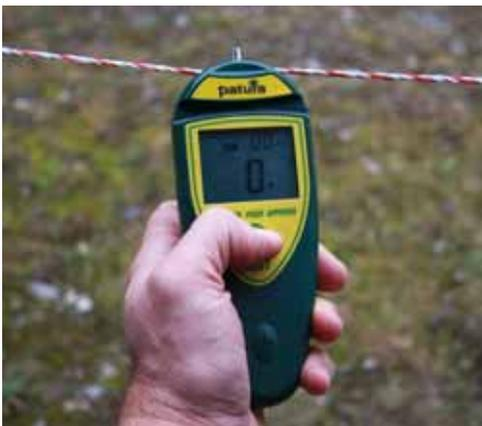
**Abbildung 5:** Ein gutes Messgerät für die Zaunspannung gehört zur Grundausrüstung. Mit ihm kann auch festgestellt werden, in welcher Richtung nach einer Störquelle zu suchen ist.
